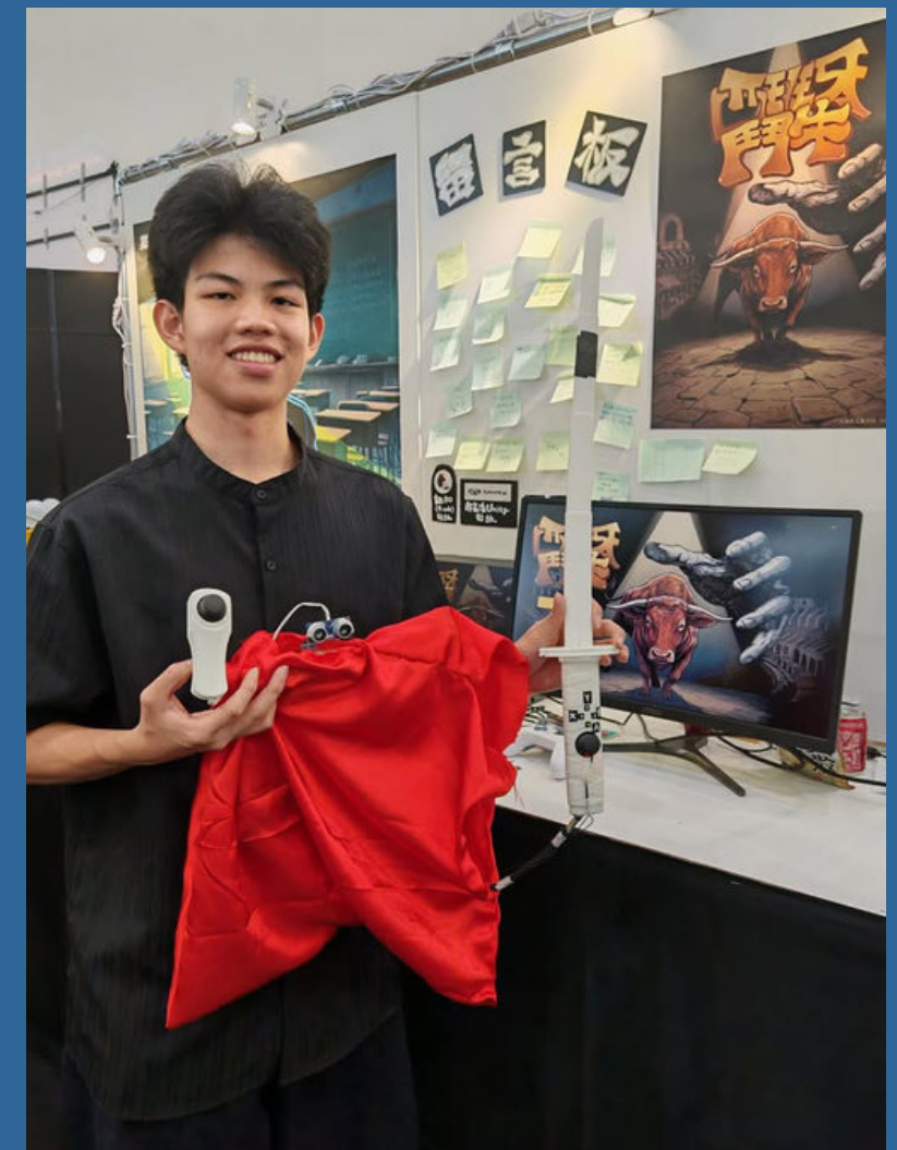
自製感測器作為搖桿 (加速度+紅外線)
